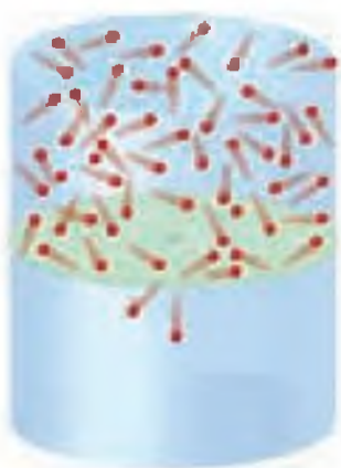
▲ Figura 10.20 Efusión. La mitad superior de este cilindro está llena de un gas, y la mitad inferior es un espacio evacuado. Las moléculas de gas efunden (escapan) a través de un agujero diminuto en la pared divisoria sólo cuando aciertan en el agujero.
